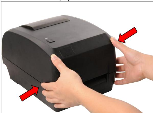
1, cambiar manos presionando la cubierta izquierda y derecha, la cubierta de arranque de la impresora
