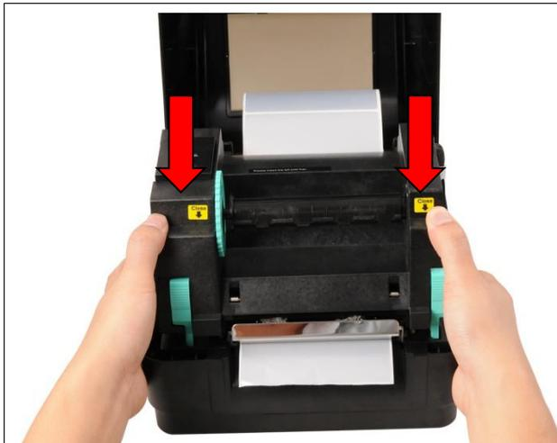
6, la mano izquierda presiona la flecha hacia abajo, cerrando el cabezal de impresión. Asegúrese de que el cabezal de impresión está completamente cerrado, para garantizar la calidad de impresión
