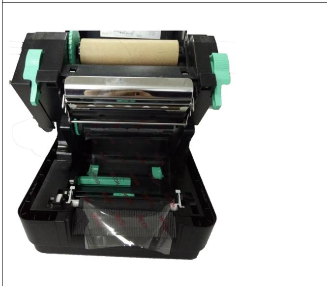
6, el lado izquierdo del eje de alimentación (extremo hexagonal) en el carrete de suministro de cinta (verde), y luego se cargan en la derecha
