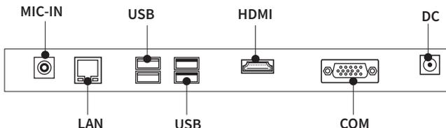
**Interfaces:** 1 puerto COM, 6 puertos USB, 1 interfaz de red RJ45 10/100/1000M, 1 interfaz de audio, 1 puerto HDMI + WIFI DUAL BAND + Bluetooth
